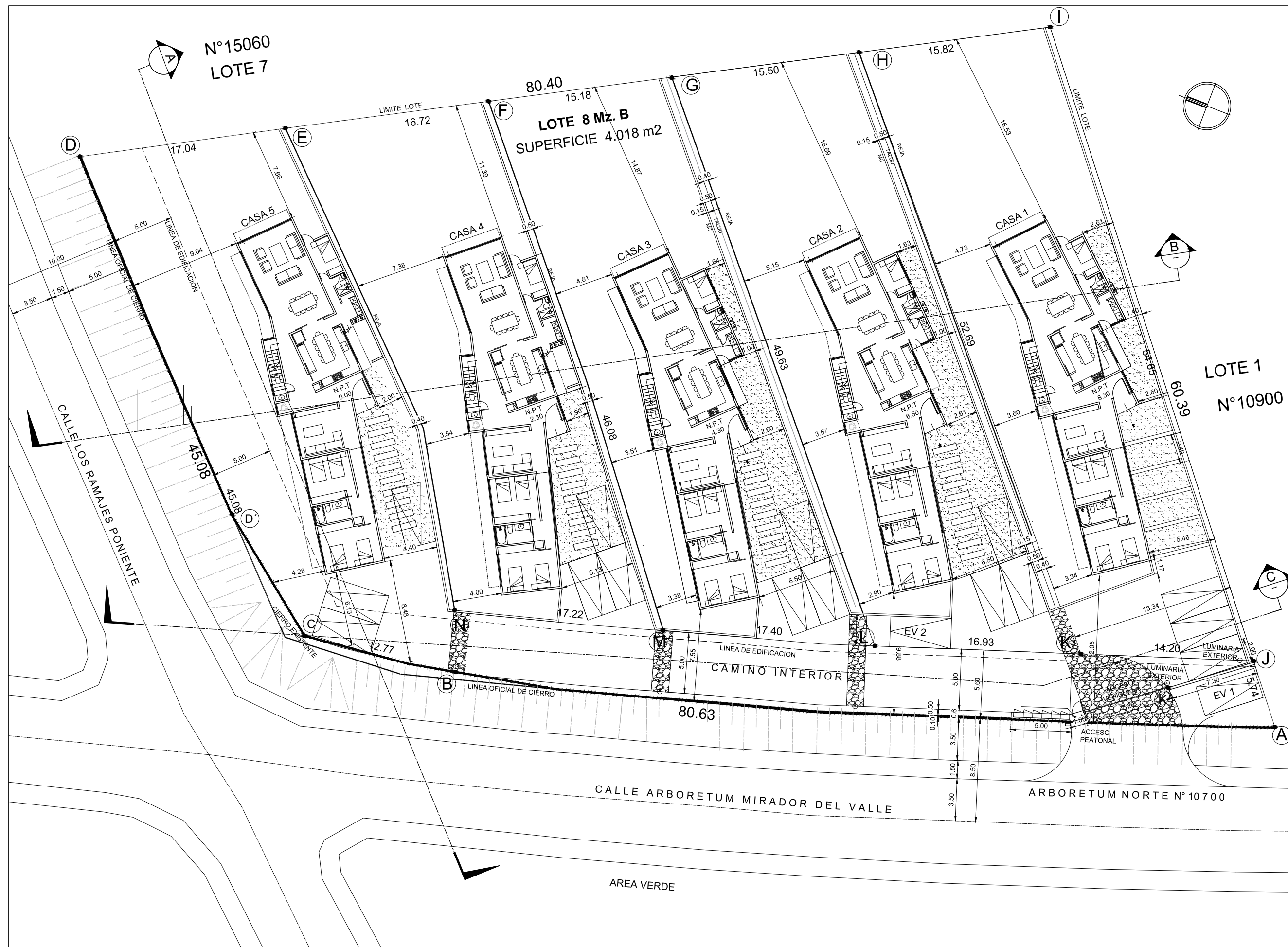
PLANTA DE EMPLAZAMIENTO PRIMER PISO ESCALA 1:200
